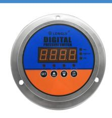
YL-814Z是一款智能型数显压力开关,集压力测量、显示、控制于一体的不锈钢数字式压力开关,该系列压力开关可设置两路常开常闭报警点,也可实现两路高低压控制,另外具有一键清零,三种显示单位切换等多种功能。
